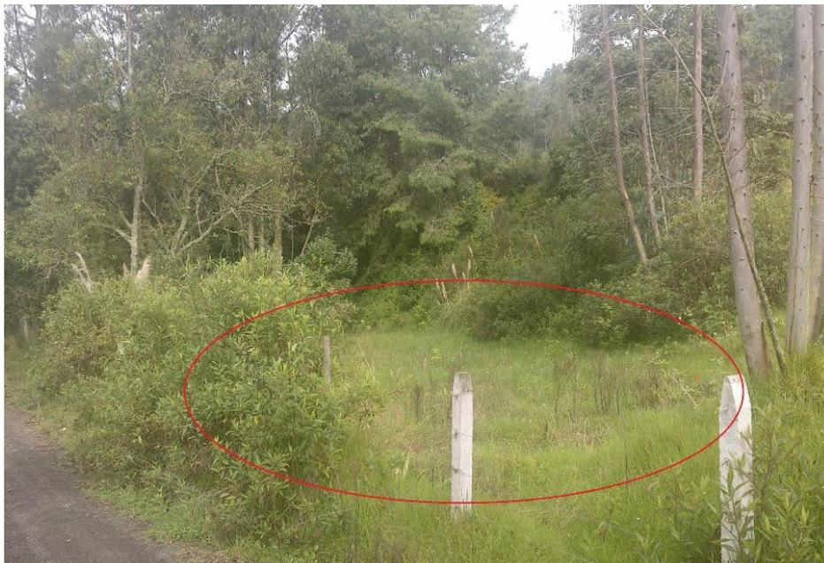
**FOTOGRAFÍA NRO. 23 ZONAS DE ACUMULACIÓN DE AGUA QUE EN ÉPOCAS DE INVIERNO SE ESTANCAN, PUDIENDO SER UN FACTOR DESENCADENANTE EN LA REACTIVACIÓN DEL DESLIZAMIENTO.
