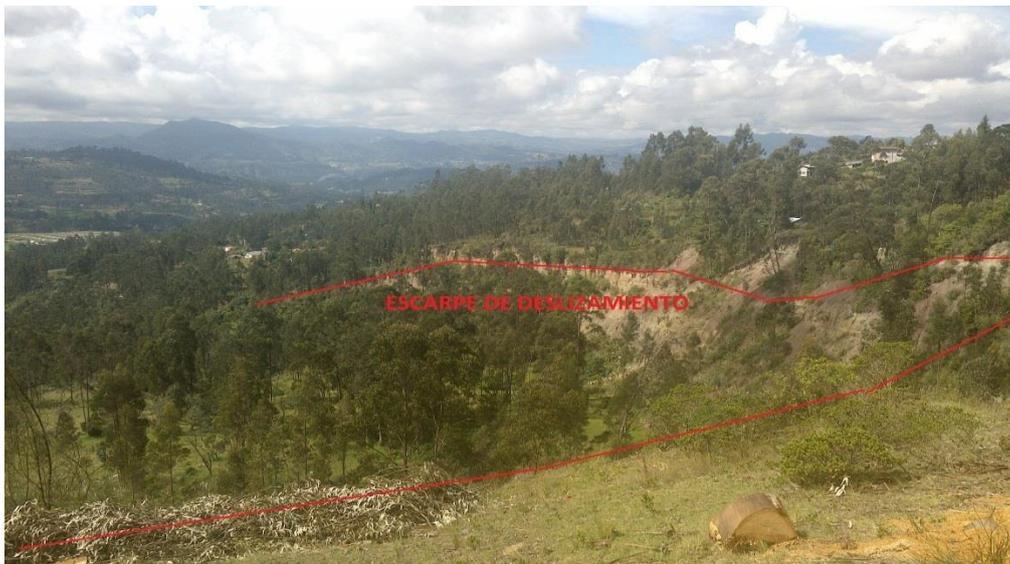
**FOTOGRAFÍA NRO. 12 ESCARPE DE DESLIZAMIENTO EN FORMA DE
